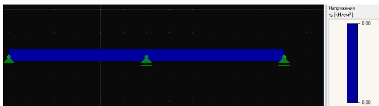
Рис. 36. Эпюра распределения касательных напряжений по длине балки от действия сосредоточенной нагрузки в каждом пролете
