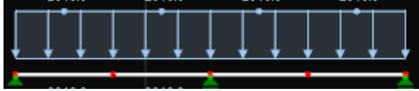
Рис. 11. Двухпролетная балка, нагруженная равномерно распределенной нагрузкой
