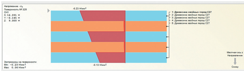
Рис. 8. Графическое представление распределения нормальных напряжений по сечению наружной стеновой панели
