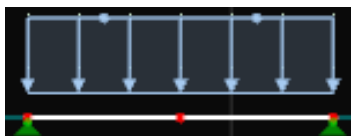
Рис. 4. Однопролетная балка, загруженная равномерно распределенной нагрузкой
