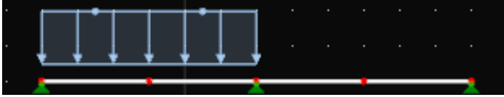
Рис. 18. Двухпролетная балка, нагруженная равномерно распределенной нагрузкой в первом пролете
