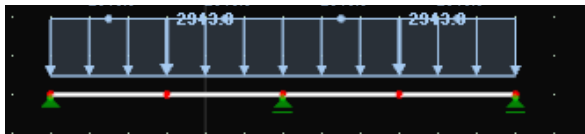
Рис. 39. Двухпролетная балка, нагруженная сосредоточенной и равномерно-распределенной нагрузкой в каждом пролете
